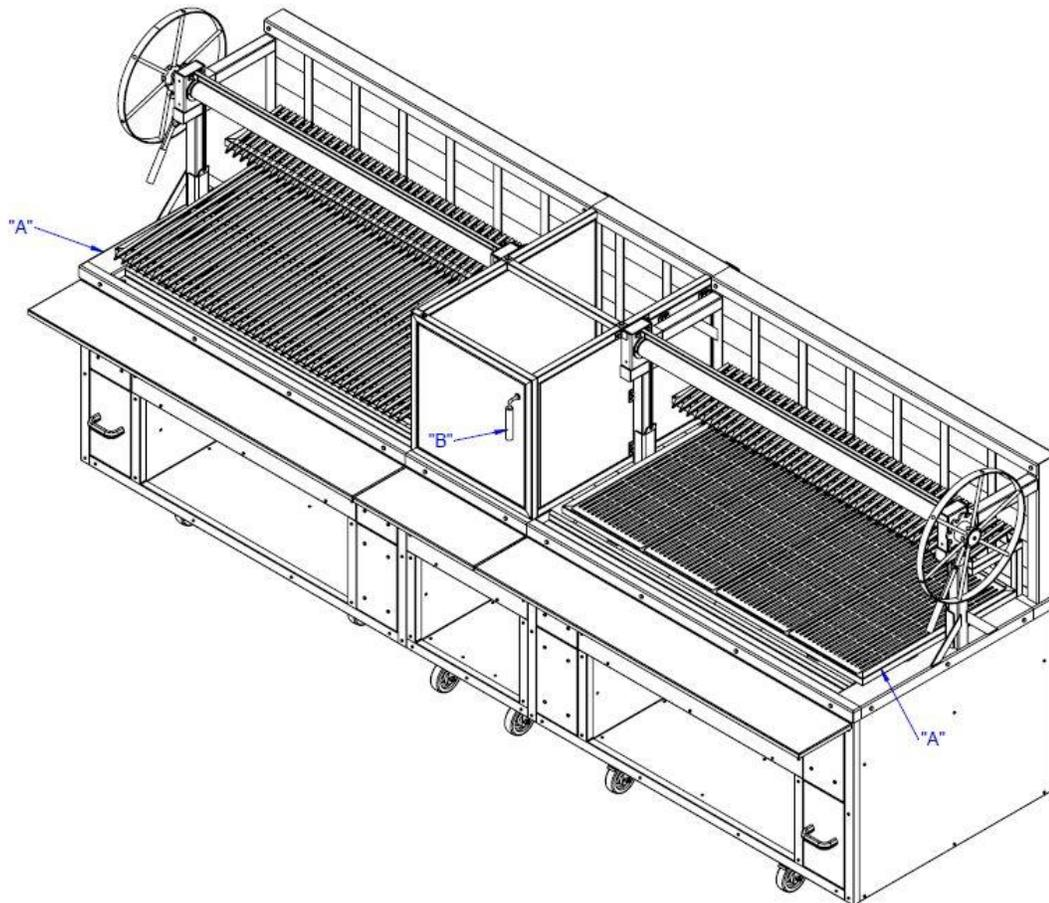
“A” Sistema grelha elevatória manual.
